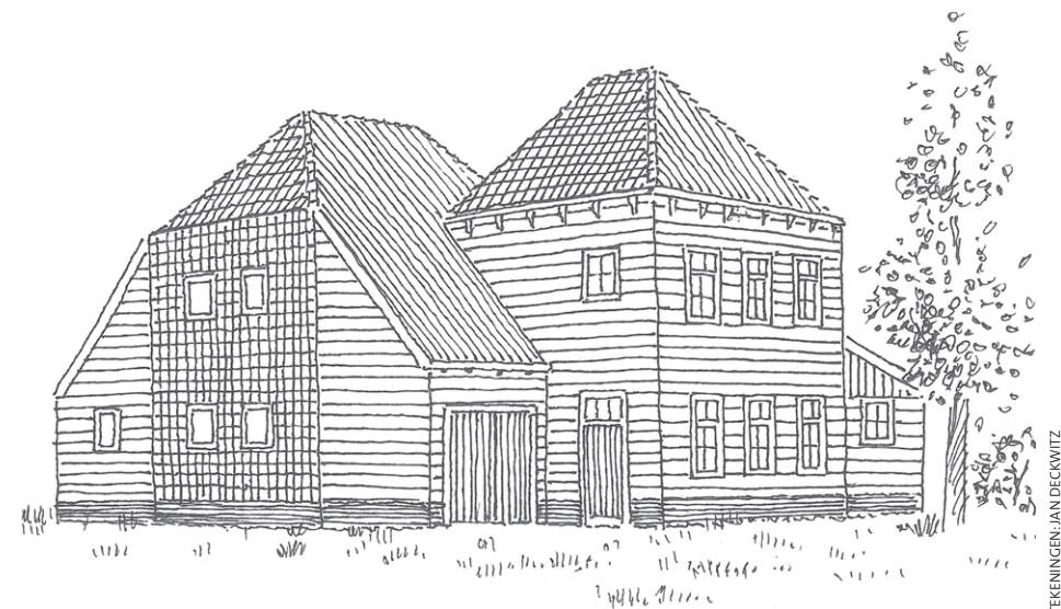
Schets voor nieuwbouw, een combinatie van afgeknotte ('onvolledige') stolp en kapberg, de vierkanten aan elkaar gekoppeld. De linkergevel getekend naar voorbeeld van een identieke stolp in Westzaan.
