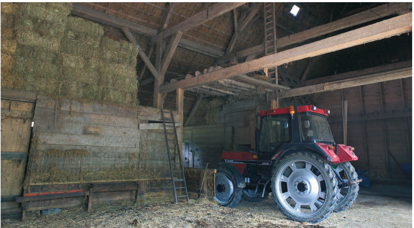
Het levert risico op brand op als een trekker met een hete motor in een schuur met hooi en stro op de vloer gestald wordt
