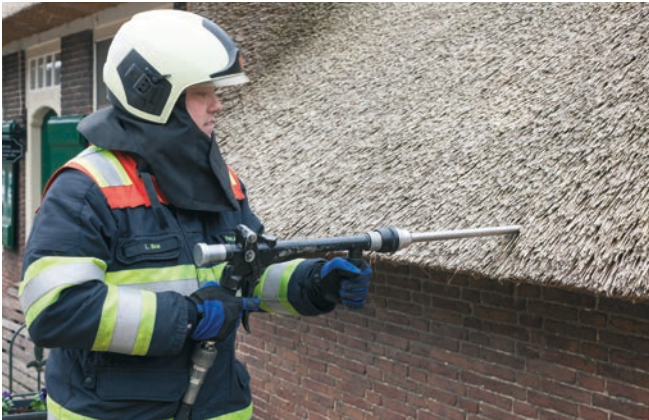
Een blusnaald is een hulpstuk om vuur in rieten daken mee te blussen
